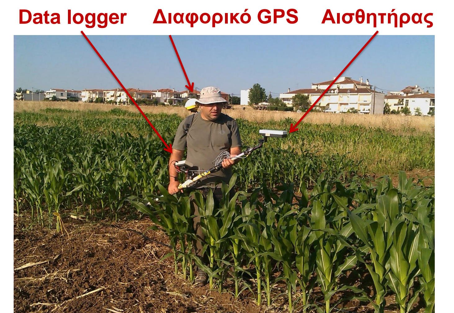
ΕΙΚΟΝΑ 3. Σάρωση με των αισθητήρα φυλλώματος για τον υπολογισμό της επιφανειακής λίπανσης
