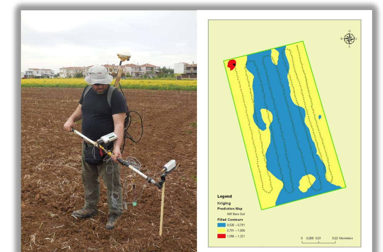
ΕΙΚΟΝΑ 4. Σάρωση με των αισθητήρα φυλλώματος στο γυμνό έδαφος για τη δημιουργία χάρτη απορρόφησης της ακτινοβολίας
